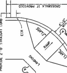
TYPICAL ONE-RAMP CORNER INSTALLATION
